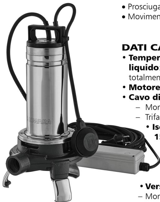
Le elettropompe della serie DOMO GRI sono equipaggiate con un sistema di triturazione estremamente efficiente ed altamente affidabile. Il tritурatore è in grado di macerare i corpi solidi presenti nelle vasche di raccolta e di pomparli attraverso tubi di scarico di diametro fino a 25 mm. DOMO GRI è disponibile con potenza 1,1 kW ed 1,5 kW. Sistema di tenuta **DRIVELUB SEAL SYSTEM**.
